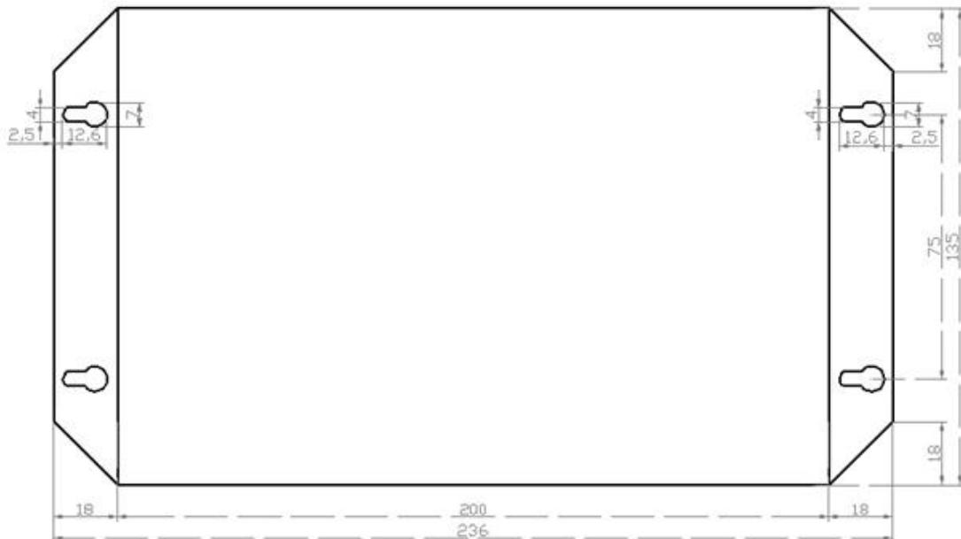
注明：以上尺寸图中单位为毫米（mm）。
